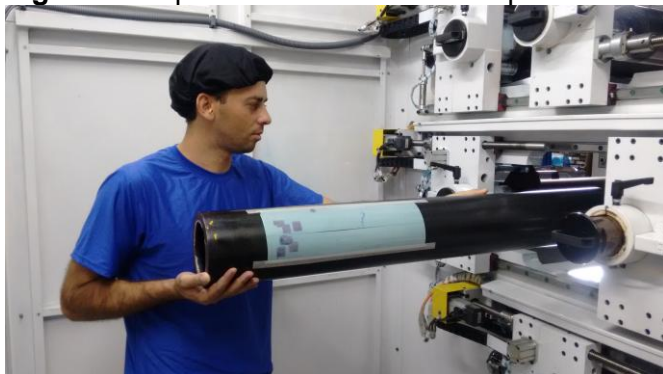
Figura 2 – Operador trocando camisa porta clichê
