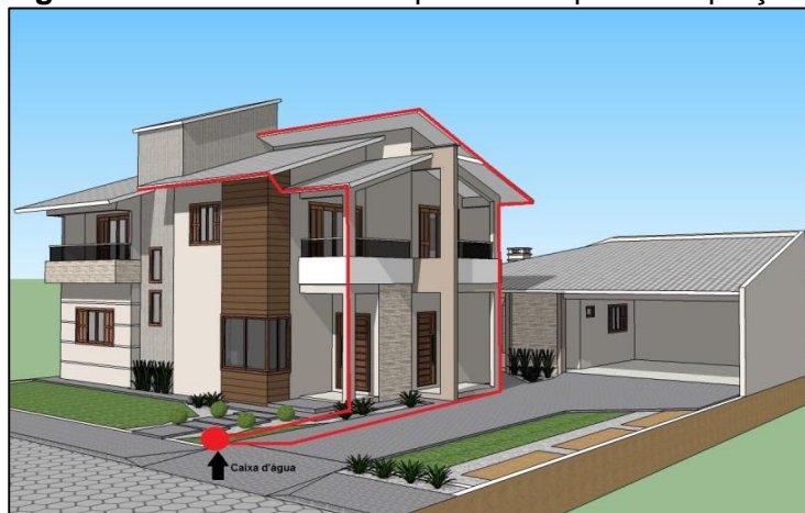
Figura 1 - Área do telhado aproveitada para a captação da água da chuva.
