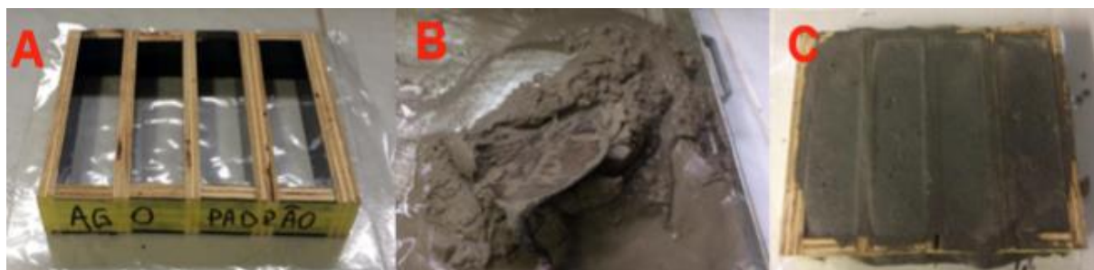
Figura 03 - (A) Moldes de madeirite plastificado; (B) Argamassa no estado fresco; (C) Preenchimento dos moldes.
