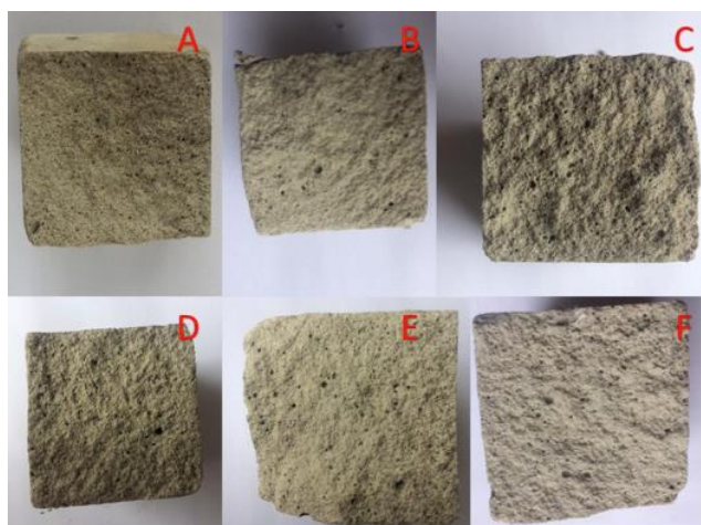
Figura 06 - Imagem interna dos corpos de prova (A) AG0, (B) AG1, (C) AG2, (D) AG3, (E) AG4 e (F) AG5.
