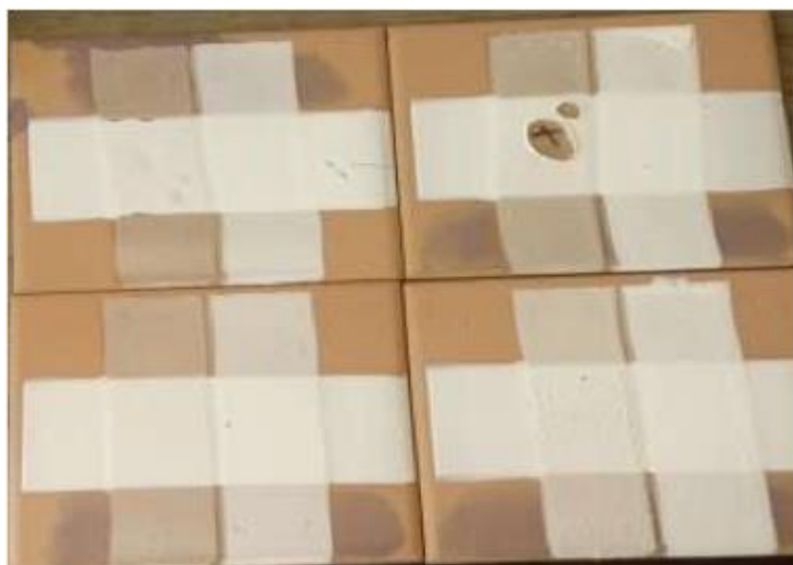
Figura 1 - Engobes cerâmicos a partir do vidro reciclado de lâmpadas fluorescentes
