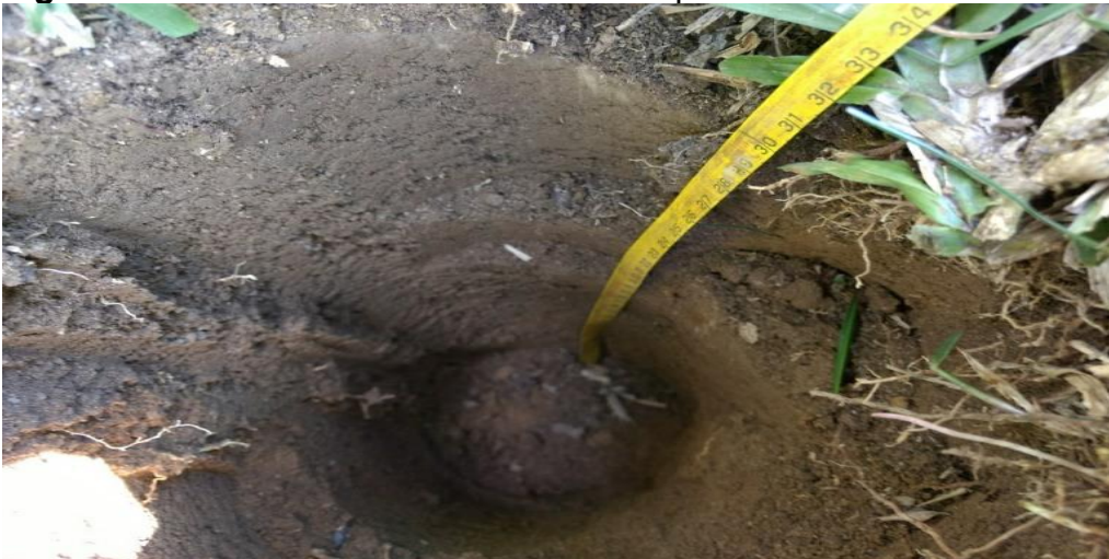
Figura 4 - Profundidade de 30 centímetros para retirar o solo.
