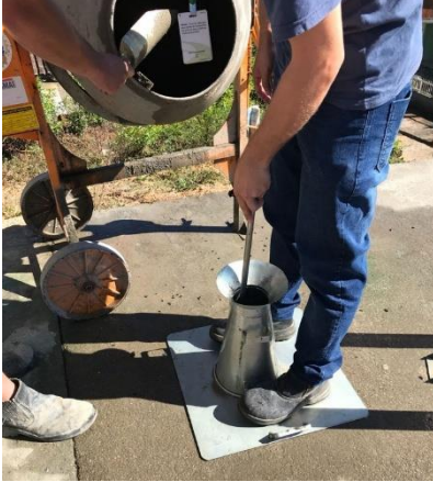
Figura 3 – Realização do slump test
