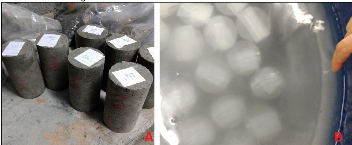
Figura 4 – Desforma dos corpos de prova: A) Retirada das formas; B) Colocação em local coberto com água
