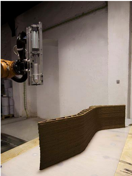
Figura 4 - Impressora 3D em escala industrial.
