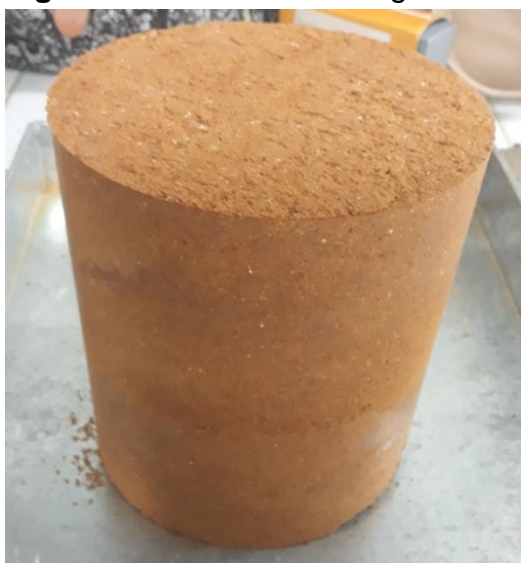
Figura 4 - Resultado da segunda compactação da amostra
