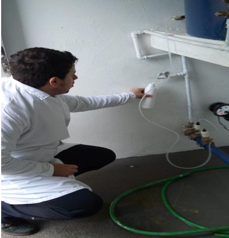
Figura 4 – Coleta da amostra da água do poço.
