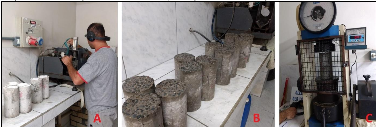
Figura 5 – Rompimento dos corpos de prova: A) Alinhamento da superfície; B) Corpos de prova com a superfície alinhada; C) Compressão dos corpos.
