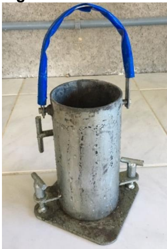
Figura 3 — Fôrma do corpo de prova.
