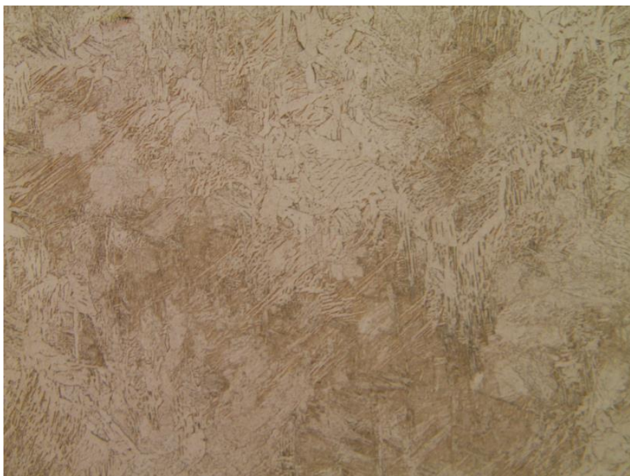
Figura 9 – Micrografia da amostra de aço 1020 temperada em água, aumento de 200X.
