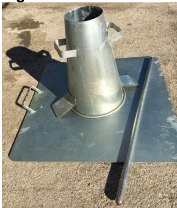
Figura 1 — Fôrma do tronco cone.
