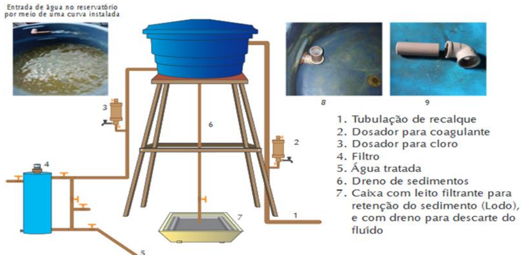
Figura 5 – Ilustração física da SALTA-Z para tratamento de águas superficiais
