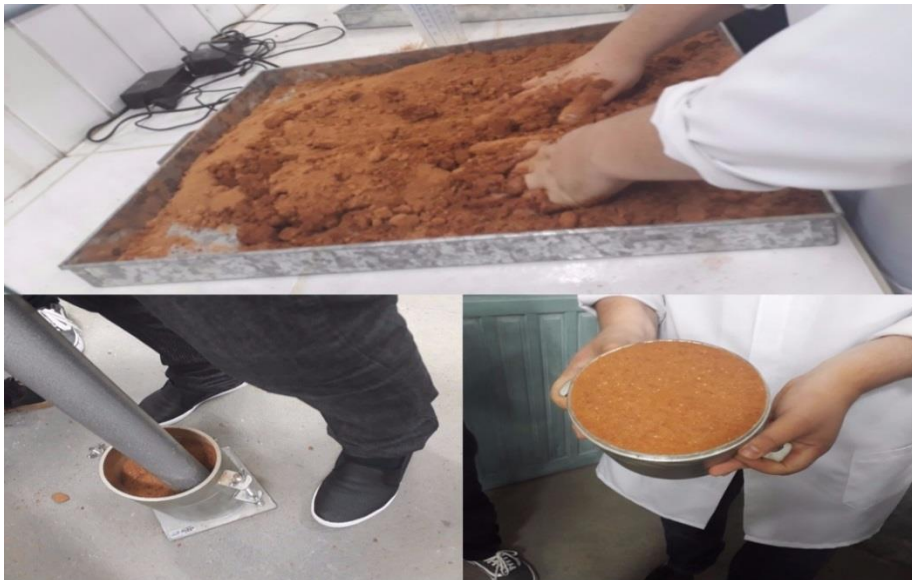
Figura 3 - Ensaio de proctor normal
