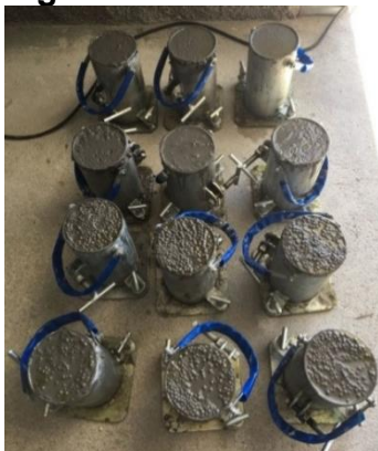
Figura 4 — Concreto nas fôrmas dos corpos de prova para a secagem de 24 horas.
