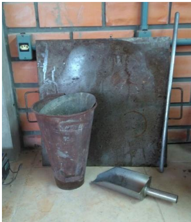
Figura 11 - Material para realização do slump test.
