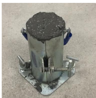
Figura 8 - Molde para corpo de prova preenchido com concreto.
