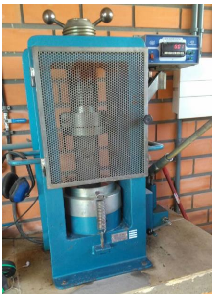
Figura 10 – PRENSA HIDRÁULICA MANUAL 100 T DIGITAL I - 3001-C – Marca Contenco
