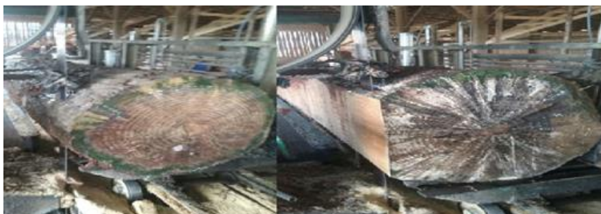
Figura 3 – Serra Fita Realizando Corte em Tora
