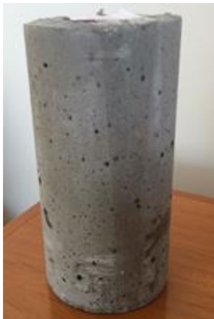
Figura 7 – Corpo de prova (com adição de 12,50%).
