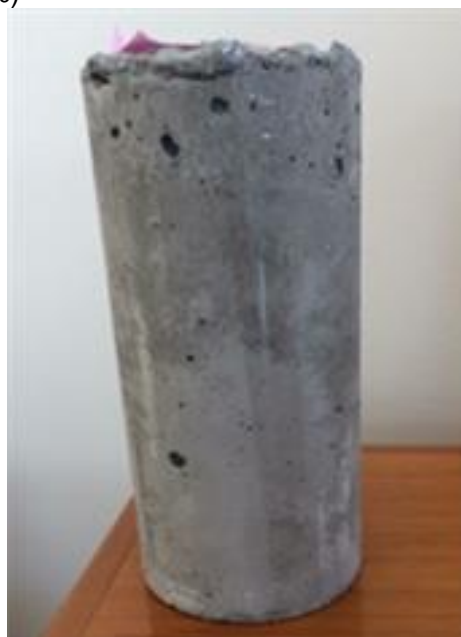
Figura 9 - Corpo de prova (com adição de 30%)
