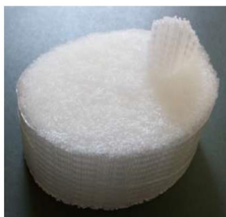
Figura 2 - Cilindro de macrofibras para lançamento direto na betoneira para mistura no concreto.
