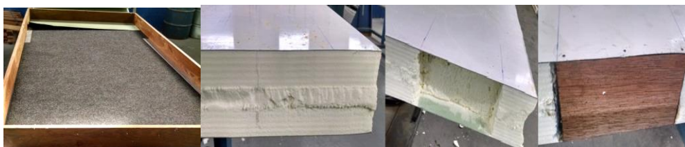
Figura 9 - Procedimento de montagem do acabamento, modelo antigo e modelo otimizado
