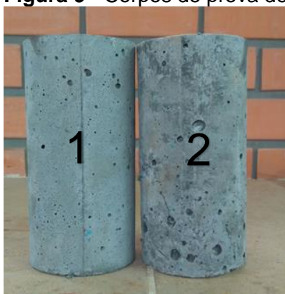
Figura 9 - Corpos de prova desenformados. (1 - Fibras; 2 - Convencional)
