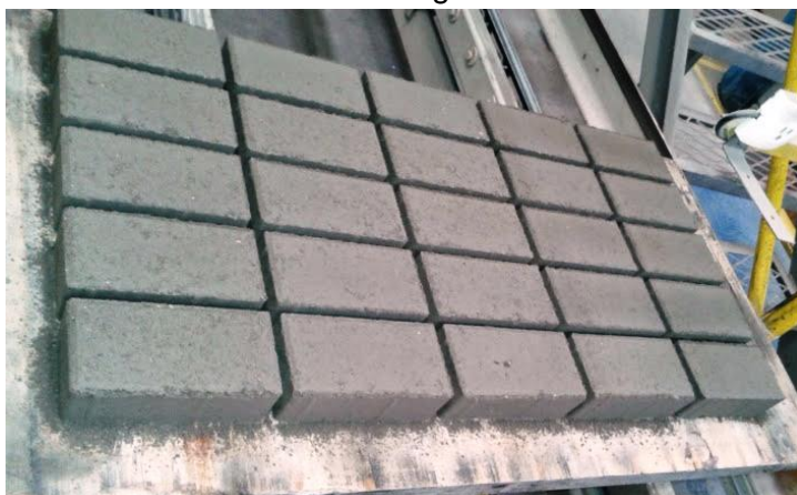
Figura 2 - Paver Cerâmico produzido com mistura de resíduo de tintas à base d'água + resíduo de resinas à base d'água
