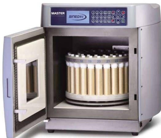
Figura 5 – Forno micro-ondas para digestão, equipamento utilizado no método USEPA 3051 a .
