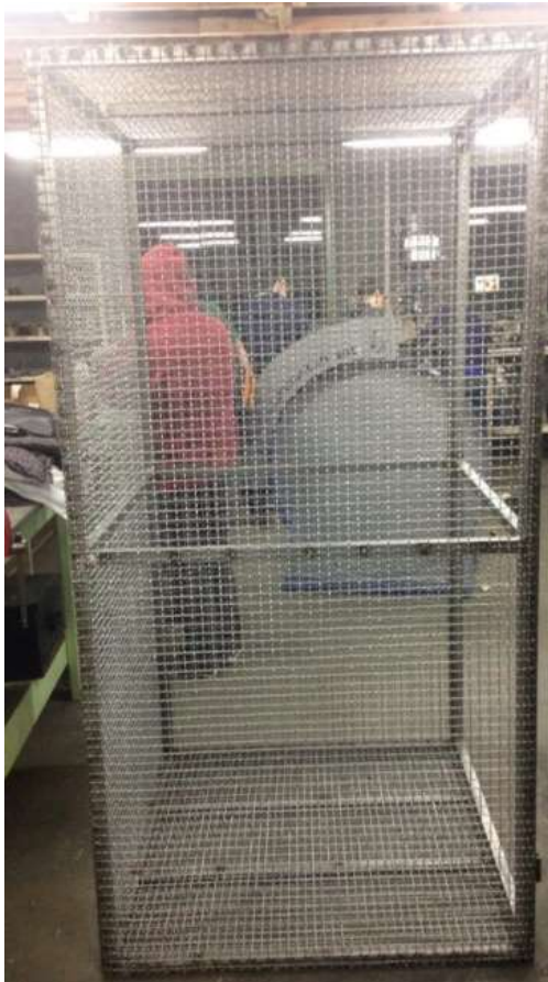
Figura 8 - Gaiola de Faraday em construção.
