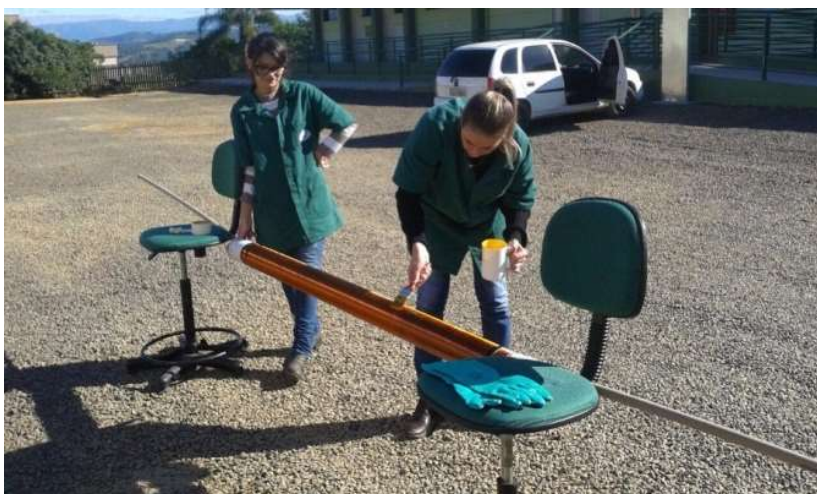
Figura 5 - Isolamento do cano de PVC.
