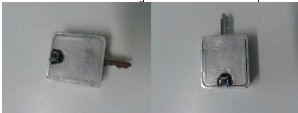
Figura 1 - Produto acabado - chave magnética com luz de LED acoplado.
