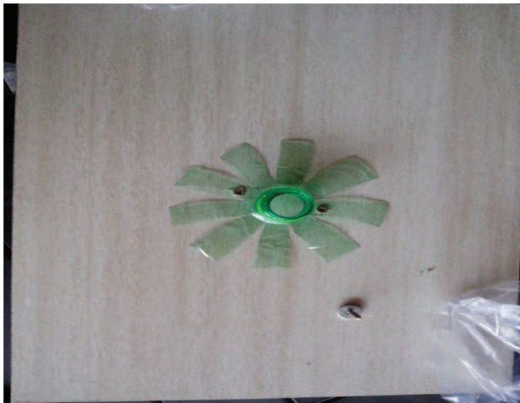
Figura 2 - Garrafa pet cortada em várias partes e parafusada na base.
