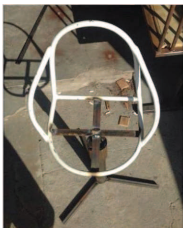
Figura 1 - Estrutura da cadeira sendo soldada.
