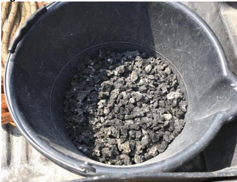
Figura 1 - Fresado asfáltico britado
