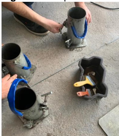
Figura 3 - Limpeza dos moldes
