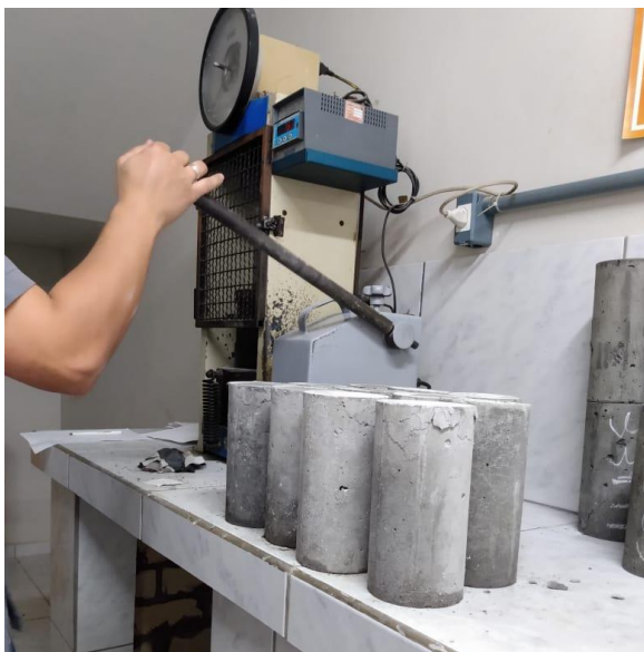
Figura 4 – Ensaio de compressão nos corpos de prova de concreto.
