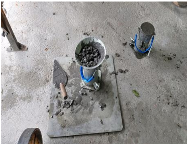
Figura 1 – Corpos de prova de concreto sendo moldados.
