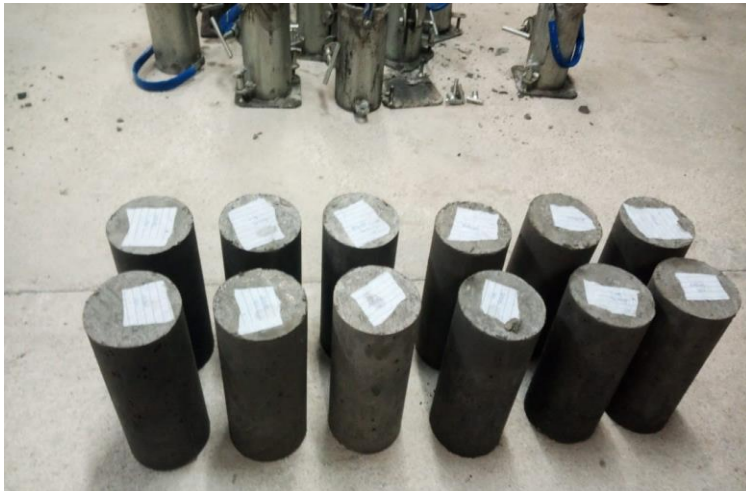
Figura 3 – Corpos de prova de concreto desmoldados.
