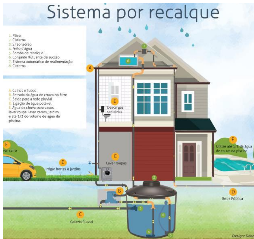
Figura 1 - Sistema de captação de água da chuva por recalque, e seus componentes.
