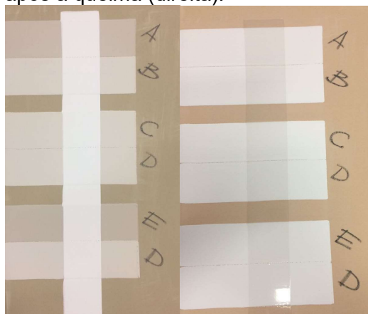
Figura 11 - Aplicação das formulações na placa cerâmica, antes da queima (esquerda) e após a queima (direita).
