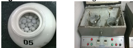
Figura 2 - Sistema de moagem utilizado nos experimentos.
