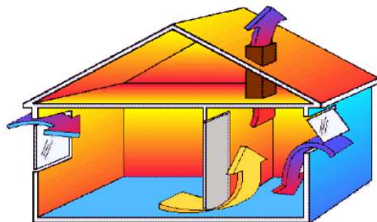
Figura 2 – Mecanismo de transferência de calor por convecção.
