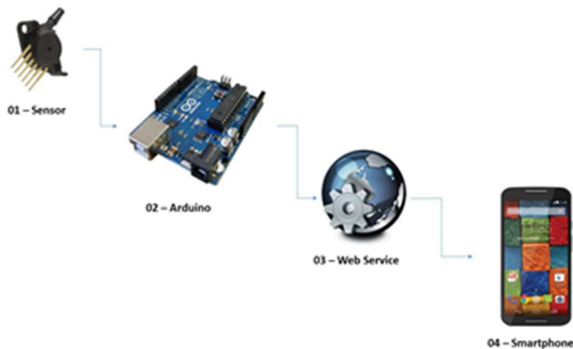
Figura 1 – Interface de comunicação utilizada no Sistema de Controle da Vazão do Gás.
