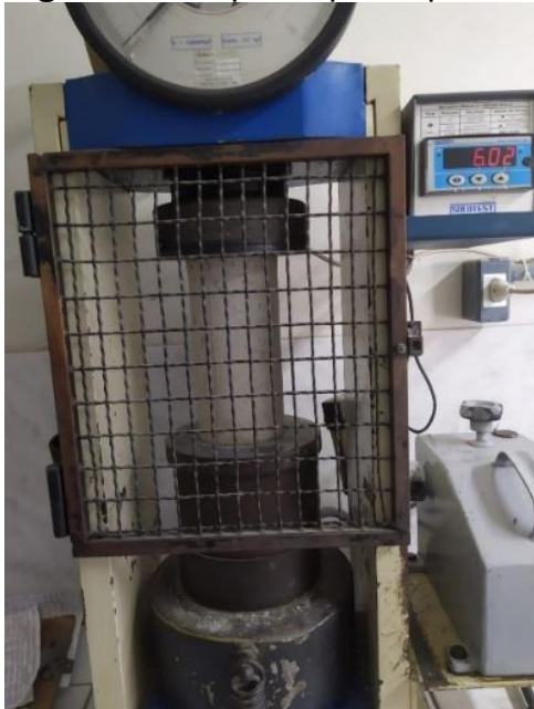
Figura 6 - Corpo de prova posicionado na prensa hidráulica.
