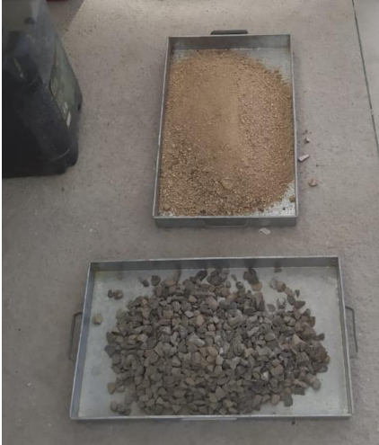
Figura 3 - Materiais pesados e separados para confecção do concreto.
