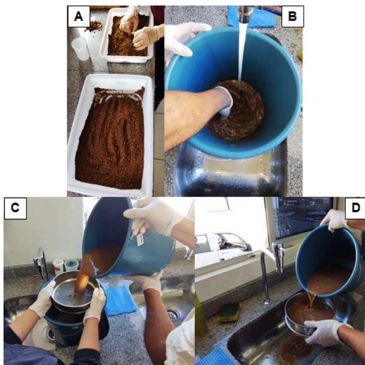
Figura 2 – Procedimento para extração de nematoides do solo. Peneiramento: A - Homogeneização das amostras de solo. B - Mistura do solo com água. C e D - Passagem pela peneira de 20 mesh e depois de 400 mesh.
