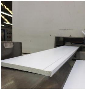
Figura 6 – Produção de rodapé no setor de Extrusão
