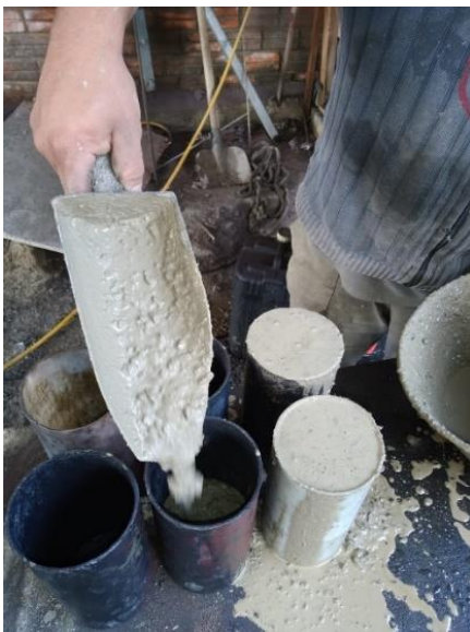
Figura 7 – Moldagem dos corpos de prova do concreto auto adensável.
