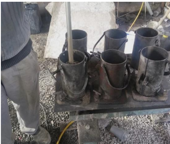
Figura 4 – Moldagem dos corpos de prova.
