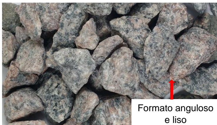
Figura 5 — AN utilizados na produção do concreto: granulometria entre 12,5 e 19 mm.
