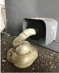
Figura 3 – Isopor sendo compactado
