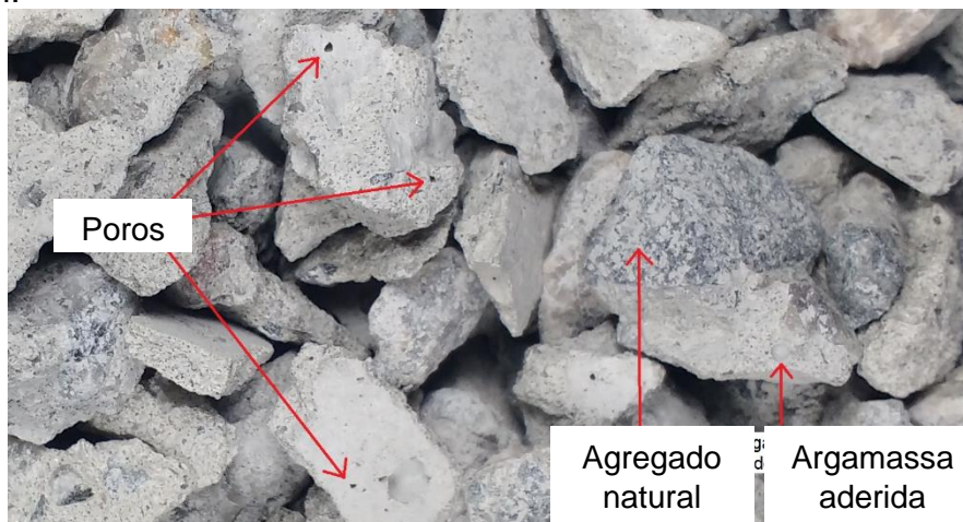
Figura 4 — ACR utilizados na produção do concreto: granulometria entre 6,3 e 12,5 mm.
