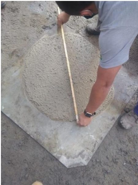
Figura 6 – Método do cone de Abrams.
