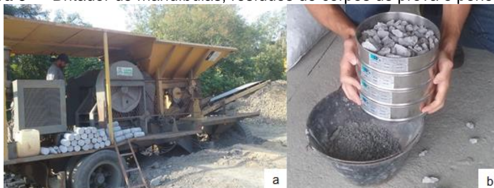
Figura 3 — Britador de mandíbulas, resíduos de corpos de prova e peneiras.
