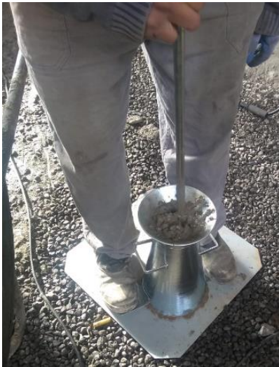
Figura 3 – Realização do Slump Test.
