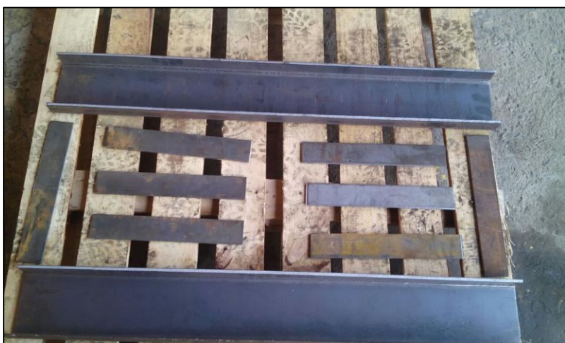
Figura 3 - Retalhos de aço cortados e dobrados
