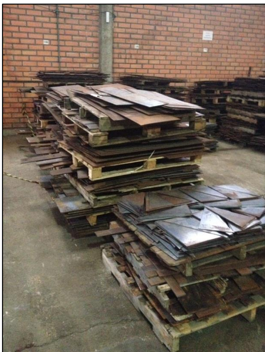
Figura 2 - Retalhos chapas de aço
