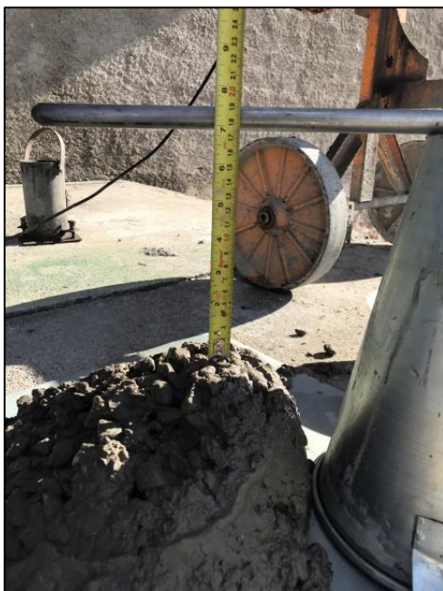
Figura 2 – Realização do ensaio de consistência ( Slump Test ).
