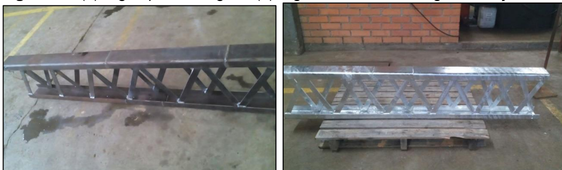
Figura 4 – (a) Viga após soldagem; (b) Viga finalizada com a galvanização
